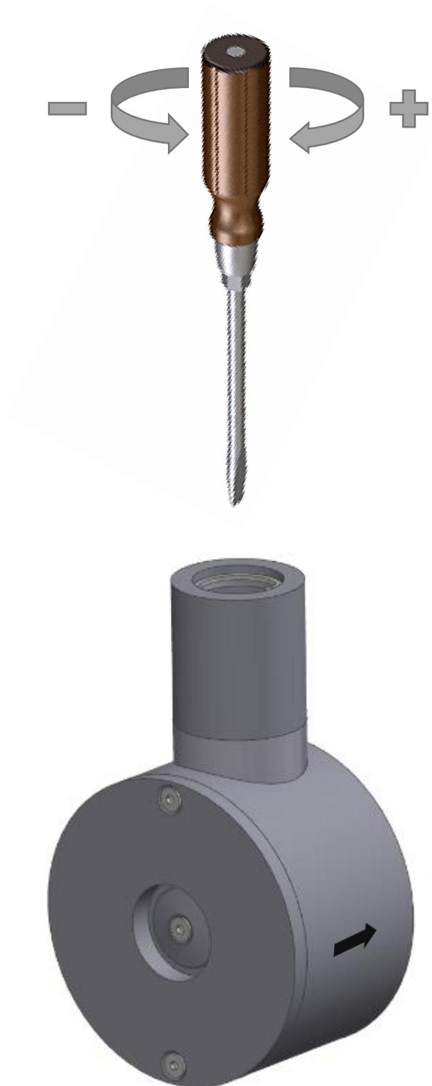
Abb. 3 Einstellen des Vordrucks (Rohrleitungen sind nicht dargestellt)
