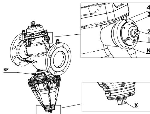
**IMPORTANTE:** Se la differenza di pressione che si stabilisce sui due lati della membrana è eccessiva, può portare al danneggiamento della membrana stessa e di altri componenti, compromettendo la funzionalità della valvola.
