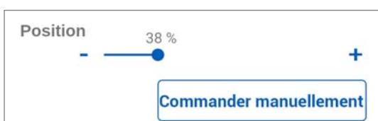
L'appui sur « Commander manuellement. » amène l'actionneur jusqu'au pourcentage d'ouverture choisi.
